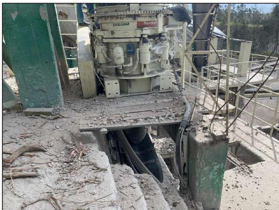
Además, se han identificado orificios en la estructura de soporte de la trituradora que representan un riesgo significativo de caída para los trabajadores. Estas deficiencias impactan directamente en uno de los factores de riesgo más relevantes, clasificado como “o10. Caída de personas a distinto nivel”, el cual obtuvo el puntaje más alto tanto en riesgo individual
